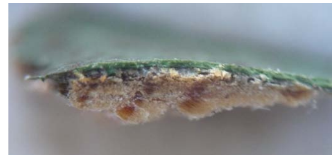
Färgflaga i mikroskop, där den grå lasyren syns svagt under det gröna färgskiktet. Under det grå syns själva träet.
